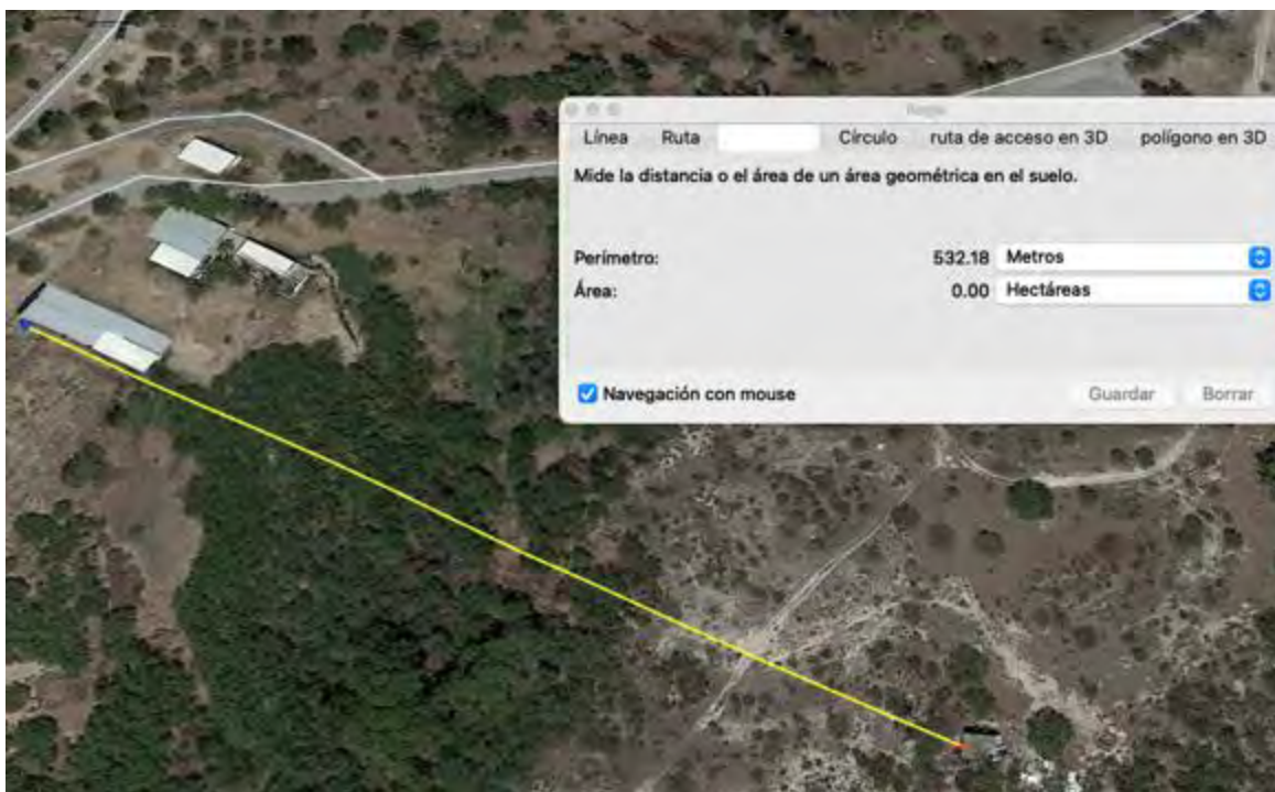
Longitud de aclareo de brecha e instalación eléctrica.
